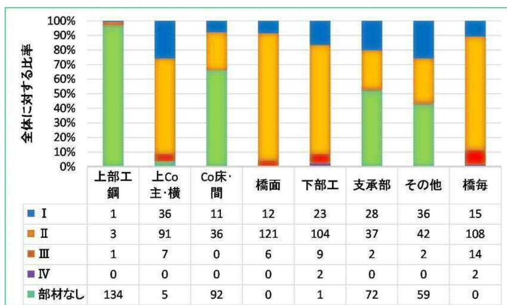
図 1.2.2 全管理橋梁の健全性の診断傾向図
