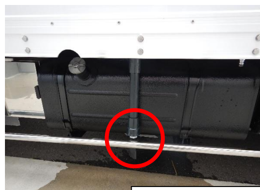
ドレン（車体左下部）
