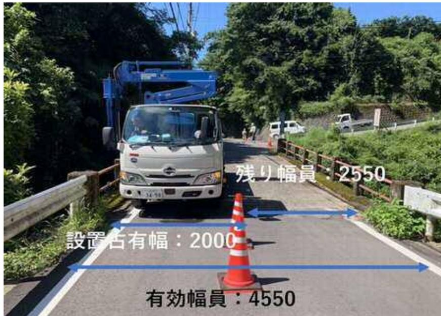
車両設置幅1.8mの道路施設点検車(YZ30FCSB)
