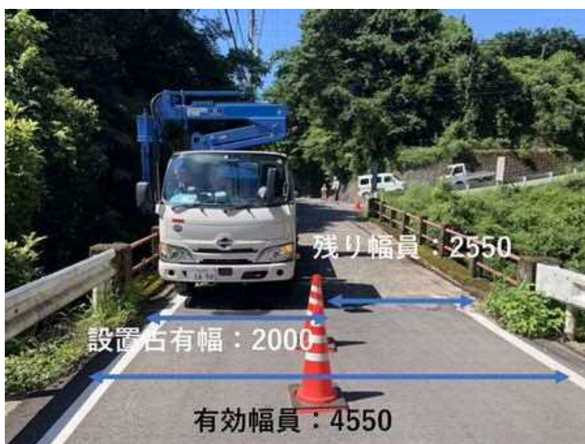
車両設置幅 1.8m の道路施設点検車(YZ30FCSB) (NETIS 登録番号：HR-200003-A)
